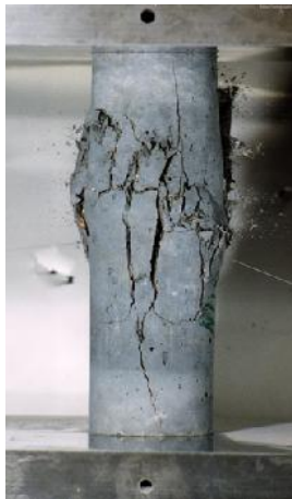
شکل ۴-۱-آزمون استاندارد تعیین مقاومت فشاری استوانه‌ای بتن
